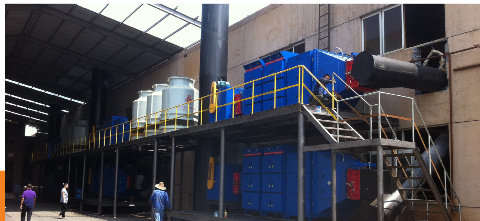
نحوه قرار گرفتن دستگاه تصفیه در محیط داخلی بر روی استتر
